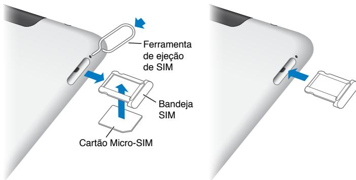
**Para abrir a bandeja do SIM:** Introduza a ponta da ferramenta de ejeção do SIM no orifício da bandeja do SIM. Pressione com firmeza, empurrando para dentro até que a bandeja salte para fora. Puxe a bandeja do SIM para instalar ou substituir o cartão micro-SIM. Se você não tiver uma ferramenta de ejeção do SIM, talvez você possa usar a ponta de um clipe de papel pequeno.
